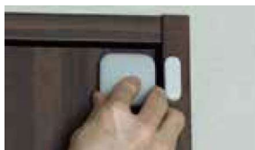
トイレや洗面所等の扉に見守りセンサーを設置
